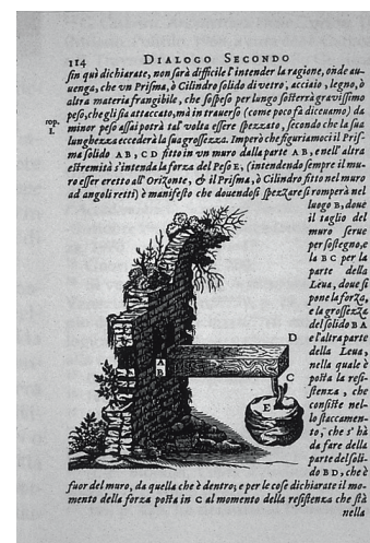
Galileo Galilei, dessin d'une poutre avec une extrémité libre et l'autre encastrée dans un mur (G. Galilei, Discorsi e dimostrazioni matematiche intorno à due nuove scienze attenenti alla Mecanica e i movimenti locali , Leida, 1638, p. 114).
