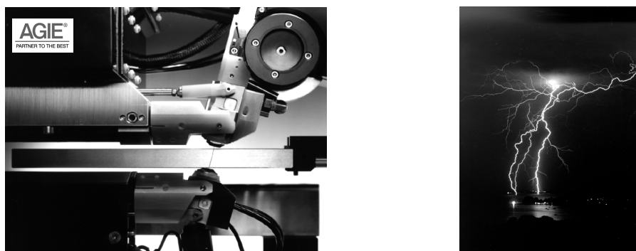
FIG. 7.1 – L'électroérosion à fil est l'un des procédés d'usinage les mieux adaptés à la fabrication de structures flexibles. L'enlèvement de matière est provoqué par des décharges électriques (éclair sur les bords du lac Léman, 1999).
