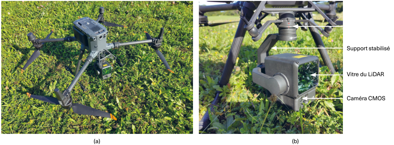
Fig. X.1.5 Drone quadricoptère matrice 350 RTK (a), équipé du LiDAR stabilisé Zenmuse LZ (b) avec caméra.
