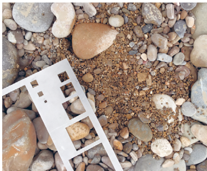
Fig. X.3.1 À gauche, tri vertical: phénomène d'armure avec des sédiments grossiers recouvrant des sédiments fins. À droite, tri longitudinal sur des bancs du Drac, en France [19] . Photos: A. Recking
