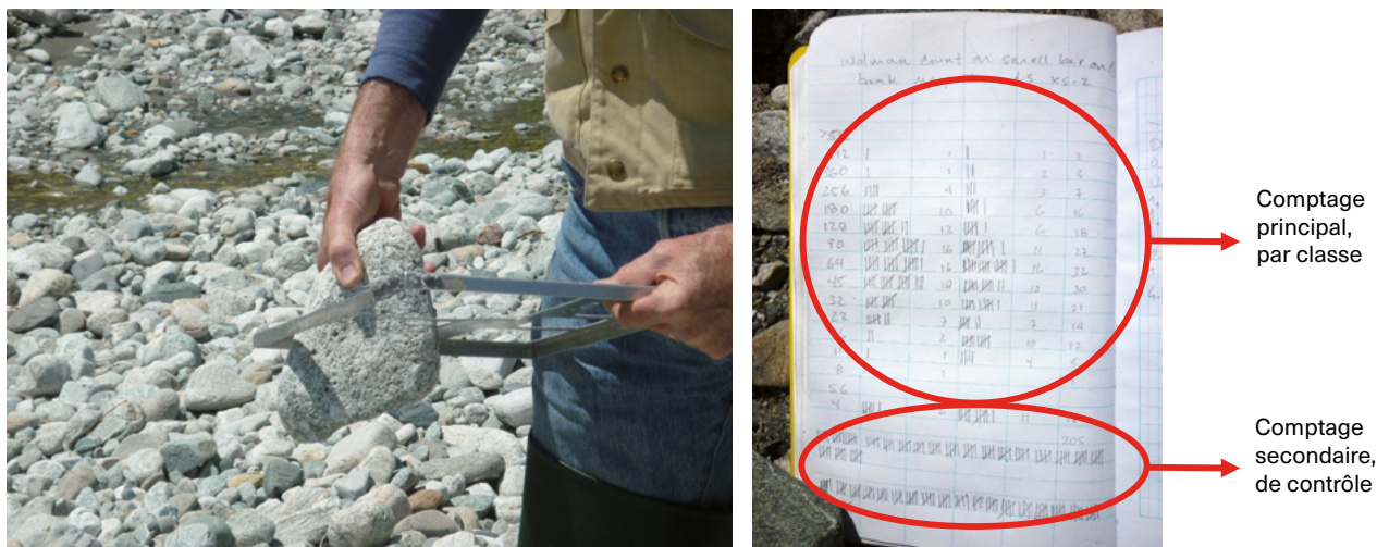
Fig. X.3.9 La mesure au granulomètre et le double comptage.
