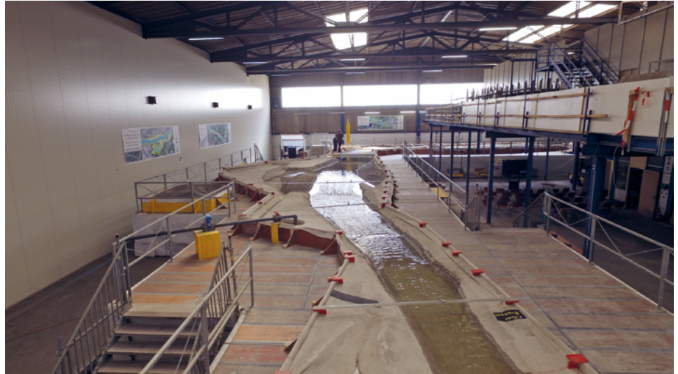
Fig. VIII.1.2 Simulation d'un débit de 250 m 3 /s du Rhône à Martigny (Valais). Échelle du modèle : 1/52 Photo : G. De Cesare
