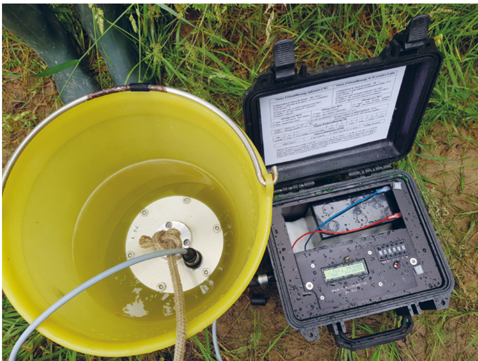
Fig. X.2.13 Calibration in situ d'une sonde fluorimétrique avec eau de rivière.
