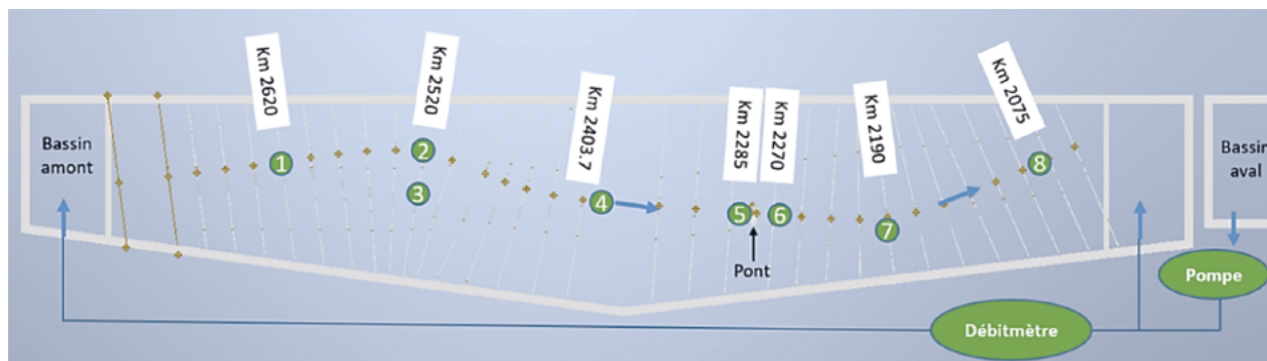
Fig. VIII.1.4 Exemple de design d'un modèle à circuit fermé, avec un bassin de tranquillisation amont, le tronçon d'étude, ainsi qu'un bassin de décantation et de contrôle de la condition limite aval (niveau). Les points numérotés indiquent les emplacements de la mesure limnimétrique.
