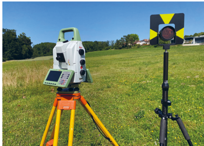
Fig. X.1.2 À gauche, station totale sur son trépied; à droite, prisme sur sa canne. Photo: K. Morel
