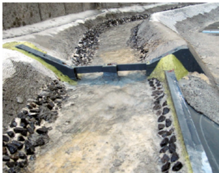
Fig. III.4.4 À gauche : modèle physique 1:30 avec seuil de contrôle et déversoir latéral. À droite : situation générale du dépotoir en rive droite de l'Avançon.
