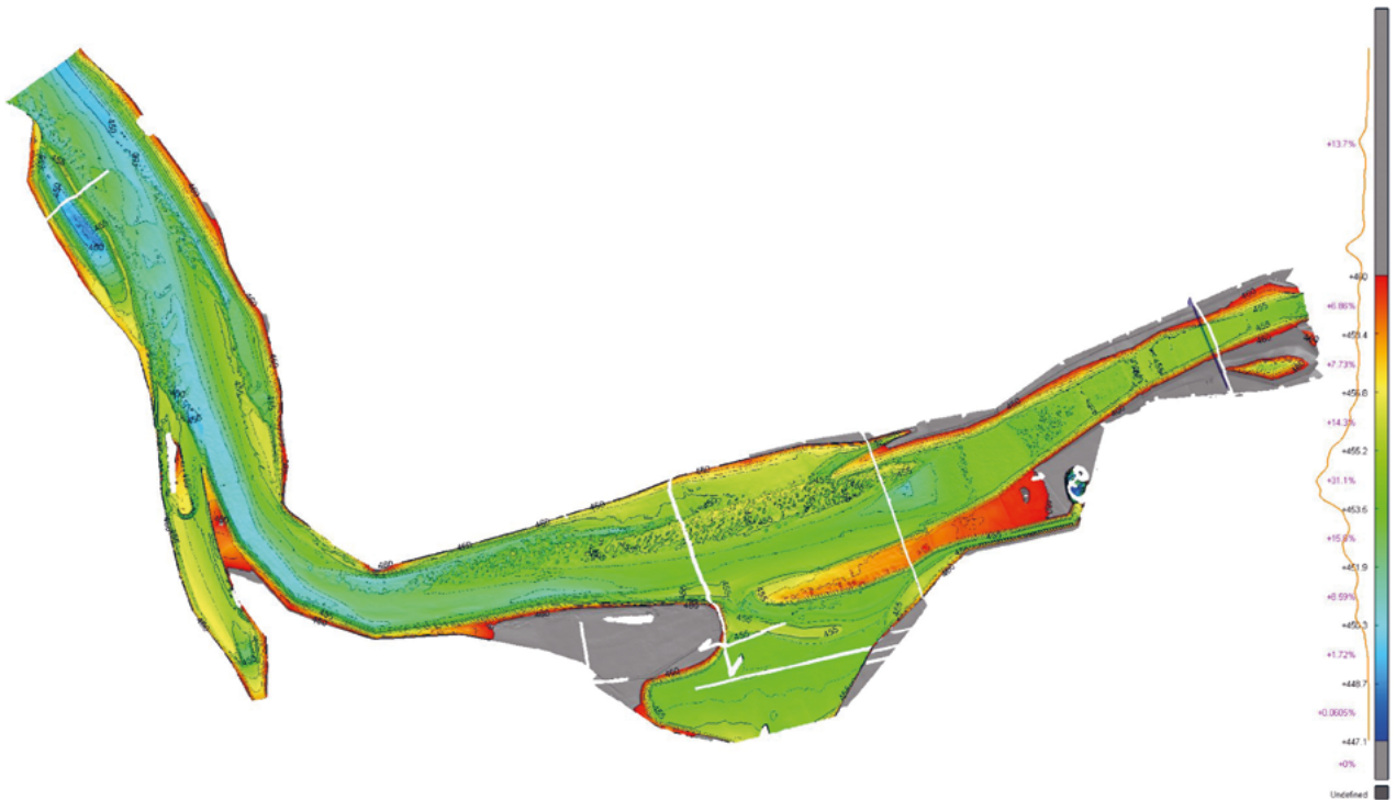
Fig. VIII.1.9 Relevé topographique effectué par LiDAR.
