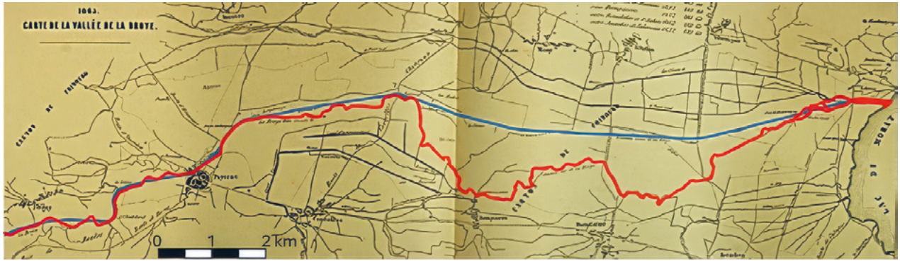
Fig. III.2.2 Correction de la Broye entre Féigny et le lac de Morat. En rouge: l'ancien tracé; en bleu: le tracé corrigé en 1865.
