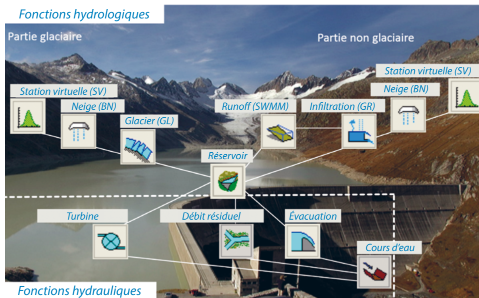
Fig. VIII.2.2 Schéma de principe de la modélisation fonctionnelle dans le logiciel Routing System.
