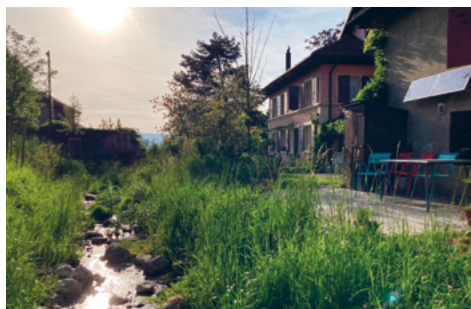
Fig. VII.1.8 À gauche: exemple de recréation d'une morphologie naturelle du lit mineur grâce à un bon dimensionnement et mélange de substrats sur le fond du lit (remise à ciel ouvert du ruisseau de Mivellaz à Corcelles-sur-Chavornay, Vaud).
