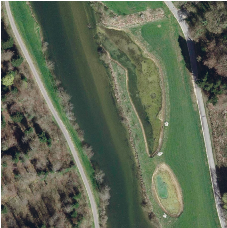
Fig. VII.1.11 Création d'annexes hydrauliques de type bras mort connecté avec différents niveaux de submersion, ainsi que de mares phréatiques sur les rives (revitalisation de la zone alluviale de la Lomenne le long du Doubs, Jura).
