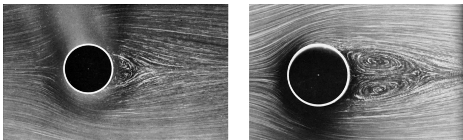
Fig. 8.2 Écoulement sur un cylindre pour Re = 13,1 (gauche) et 26 (droite).
