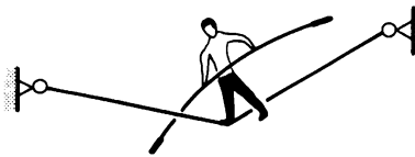
Fig. 5.3 Transmission par efforts normaux (câbles et treillis).
