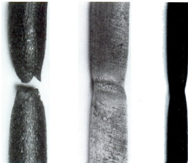
Fig. 7.2 Striction d'éprouvettes de traction (photo A. Herzog).
