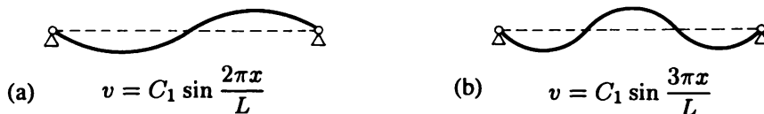
Fig. 20.15 Deuxième et troisième modes de flambement de la poutre d'Euler : (a) mode 2 ( n = 2 ) ; (b) mode 3 ( n = 3 ).
