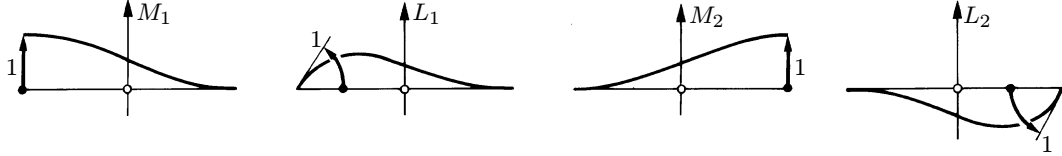
Fig. 4.10 Fonctions d'interpolation de l'élément de poutre continue (Bernoulli–Navier).
