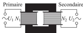
**FIGURE 14.17** Transformateur: le champ magnétique alternatif engendré dans le primaire est canalisé par le noyau de fer vers le secondaire où ses variations engendrent une tension induite (d'après JOSEF SCHREINER, *Physik für die Oberstufe der Mittelschulen*).
