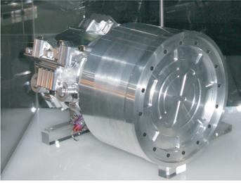
**FIGURE 7.23** Volant d’inertie (KERS) développé par la firme Flybrid pour la Formule 1. (Photo: Geni (CC)).
