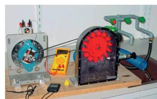
FIGURE 3.4 Couplage turbine-générateur.
