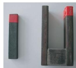
**FIGURE 13.4** Aimant droit et aimant en U. La partie colorée est ce que l'on appelle le pôle nord.
