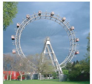
**FIGURE 9.54** Lorsque la grande roue du Prater à Vienne se met à tourner, les cabines gardent toujours la même orientation. Dans un écoulement irrotationnel, les particules du fluide en rotation se comportent de la même manière que les cabines : elles gardent toujours la même orientation, elles ne tournent pas sur elles-mêmes. (Photo : David Monniaux (CC)).
