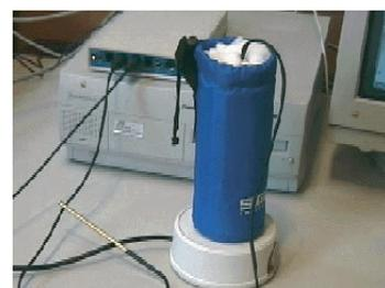
**FIGURE 5.43** Réchauffement d'eau dans un environnement chaud. L'eau est contenue dans une gourde isolée et est brassée continuellement au moyen d'un mélangeur magnétique.
