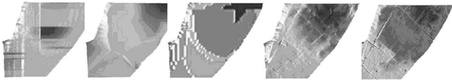
Fig. 2.6 MNAs obtenus sur la base de différentes données sources et méthodes d’interpolation. De gauche à droite : raster puis TIN ( Triangular Irregular Network ) produit par l’Office Fédéral de la Topographie, raster produit par l’TUGL (Institut de Géophysique de l’Université de Lausanne), raster issus de la photogrammétrie de photographies aériennes et de l’analyse de mesures Laser aéroportée (Metzger, 2002). Les discontinuités spatiales liées aux voies de circulation présentes sur la zone n’apparaissent (partiellement cependant) que sur le dernier MNA (d’après Metzger, 2002).
