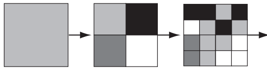
Fig. 12.20 Principe d'un modèle de désagrégation basé sur une cascade multiplicative discrète. Le volume précipité sur le domaine spatial initial est distribué sur b sous-domaines, et ainsi de suite.
