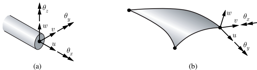
Fig. 11.28 L'assemblage d'une poutre spatiale avec une coque est incompatible au niveau des degrés de liberté nodaux : (a) poutre, six déplacements ; (b) coque, cinq déplacements.
